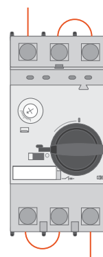
Подключение однофазного двигателя
