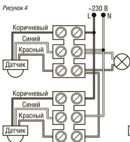
5. Для расширения зоны обнаружения применяется параллельное подключение датчиков движения согласно рисунку 4.
