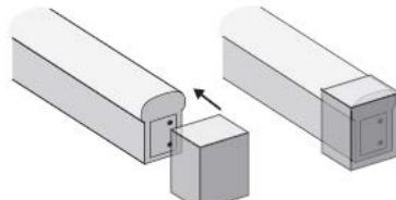
На незадействованные концы ленты необходимо установить силиконовые заглушки (в комплекте поставки). При установке заглушки, для обеспечения герметизации, рекомендуется использовать специальный клей-герметик.
