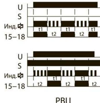
Рисунок 4. Схемы работы реле PWD, PBO1 – PBO5, PWC
