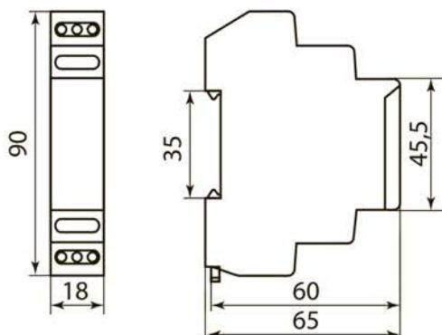
Рисунок 1. Габаритные и установочные размеры реле, мм
