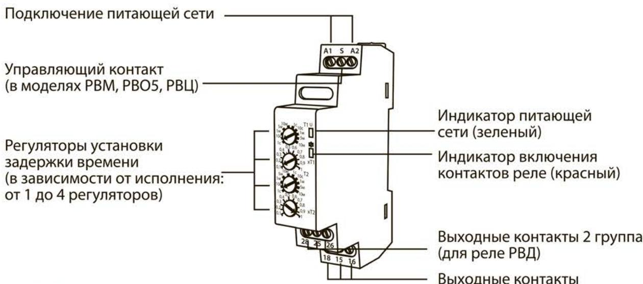
Рисунок 3. Лицевая панель реле
