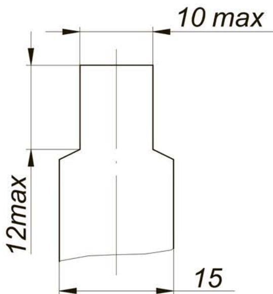
**Рисунок 1** - Форма и размеры присоединяемой шины максимального сечения
