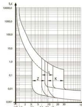
Рисунок Б.8 Защитная характеристика по ГОСТ Р 50030.2 в цепи постоянного тока при температуре плюс 45°C.
