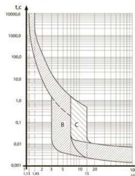
Рисунок Б.6 Защитная характеристика по ГОСТ ИЕC 60898-2 в цепи постоянного тока при контрольной температуре плюс 45°C.
