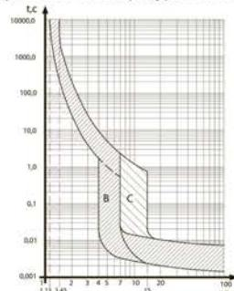
Рисунок Б.3 Защитная характеристика в цепи постоянного тока по ГОСТ ИЕC 60898-2 при контрольной температуре плюс 30°C.
