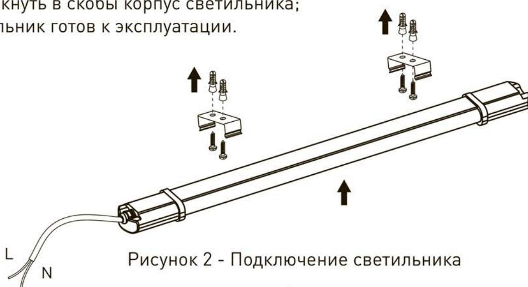
Рисунок 2 - Подключение светильника
