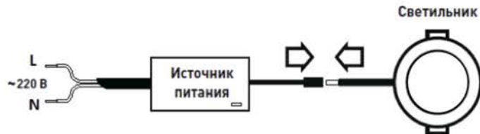
Рис. 1. Подключение светильника к сети переменного тока 220В.
