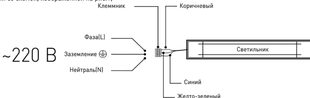
Рис.1. Схема подключения светильника к сети 220В.
