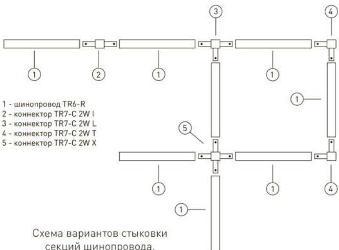
С помощью дополнительных коннекторов (поставляются отдельно) можно стыковать секции шинопровода в различных комбинациях.
