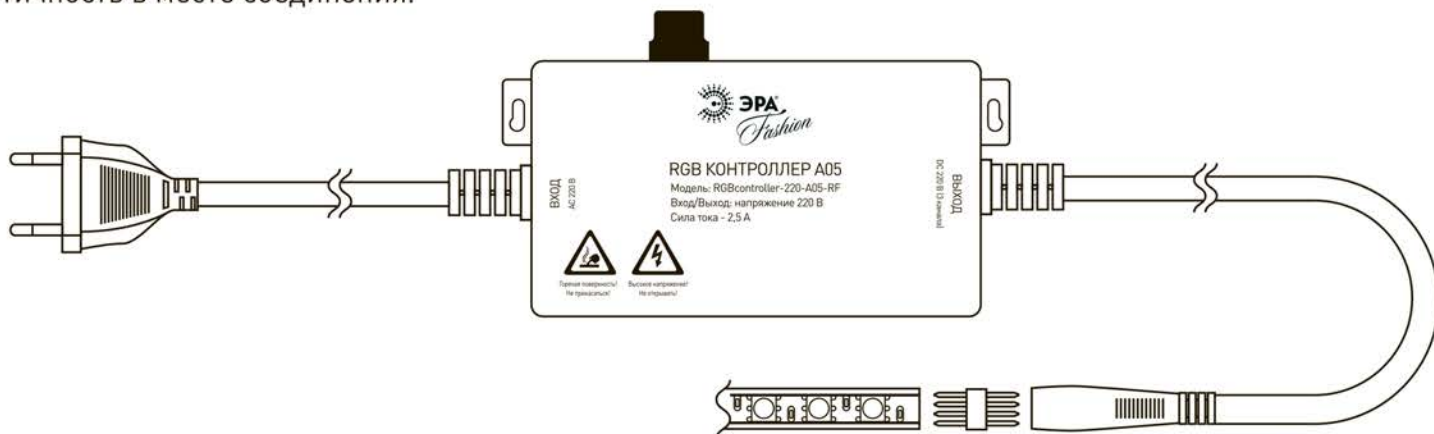
Рис.3. Подключение участка светодиодной RGB ленты к источнику питания.
