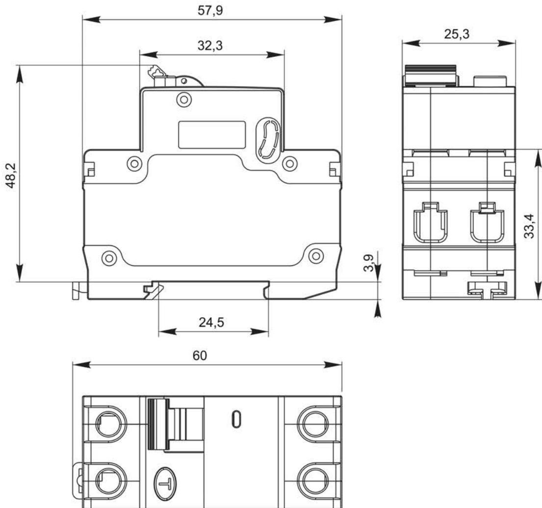
Рисунок 1 – Габаритные и установочные размеры АВДТ
