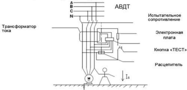
В) Рис. 2 Аппарат 3P+N: четыре проводника.
