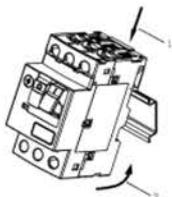
Рис. 3. Установка автоматического выключателя ВА-431 на дин-рейку.
