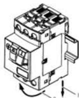
Рис. 3. Демонтаж автоматического выключателя ВА-431 с дин-рейки.
