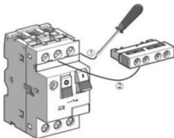
(1) Для установки фронтального контакта необходимо удалить заглушку, которая находится под вводными клеммами автоматического выключателя.
