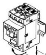
Рис. 3. Демонтаж автоматического выключателя BA-431 с дин-рейки.
