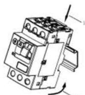
Рис. 3. Установка автоматического выключателя BA-431 на дин-рейку.
