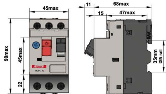
Рис. 2. Габаритные и установочные размеры автоматических выключателей BA-431, мм.
