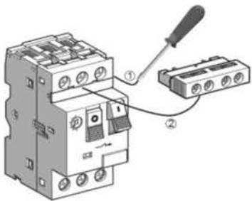
(1) Для установки фронтального контакта необходимо удалить заглушку, которая находится под вводными клеммами автоматического выключателя.
