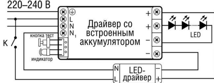
Схема подключения БАП в светильнике NLP-S2-A
