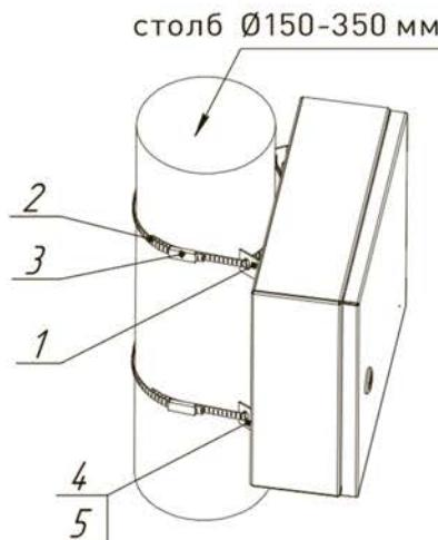
Рис. 1.2. Схема монтажа на столб
