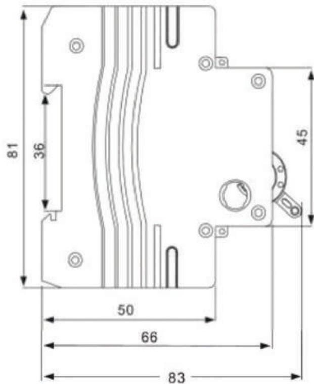
Рисунок В.1 Габаритные, установочные и присоединительные размеры выключателей
