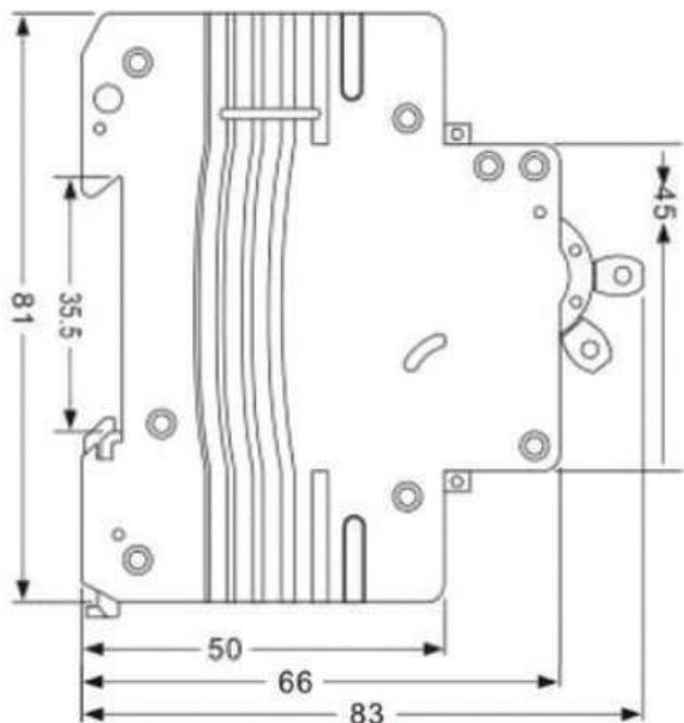
Рисунок В.2 Габаритные, установочные и присоединительные размеры выключателей
