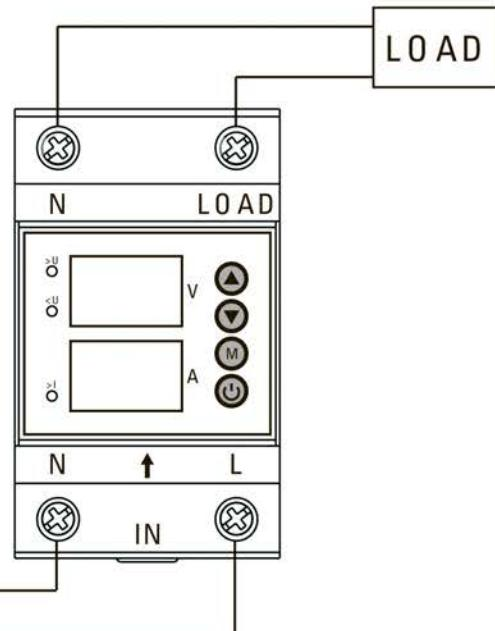
Рисунок 7 – Условная схема подключения
