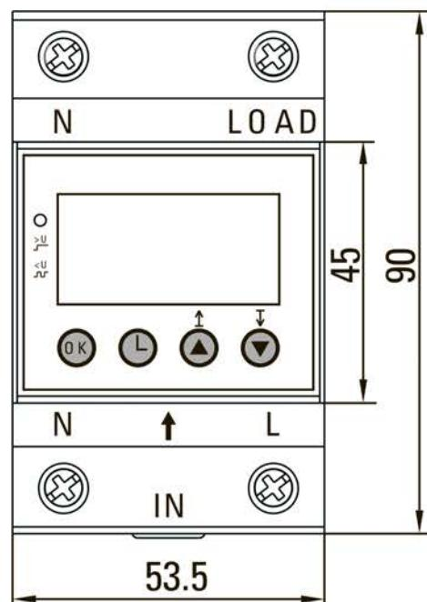
Рисунок 9 – габаритные и установочные размеры
