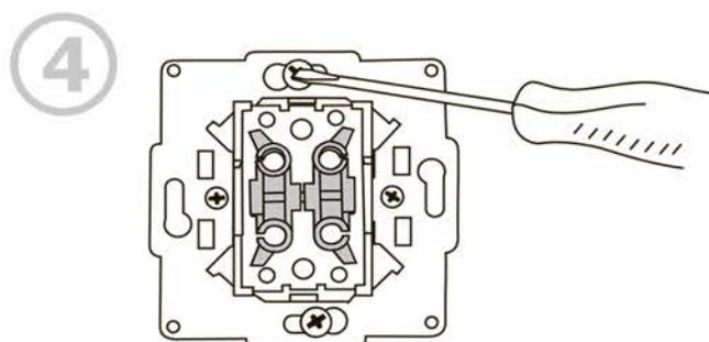
Установить механизм изделия в углублении стены, зафиксировать стопорные винты, затянув их до упора.
