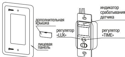
Рисунок 11 – Конструкция датчика движения ДД-028
