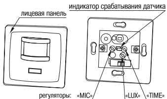
Рисунок 15 – Конструкция датчика движения ДД-035
