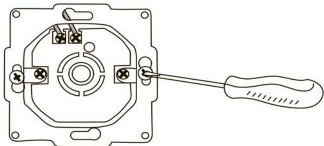
Установить механизм изделия в углубление стены, затянуть стопорные и крепежные винты на корпусе изделия до упора.
