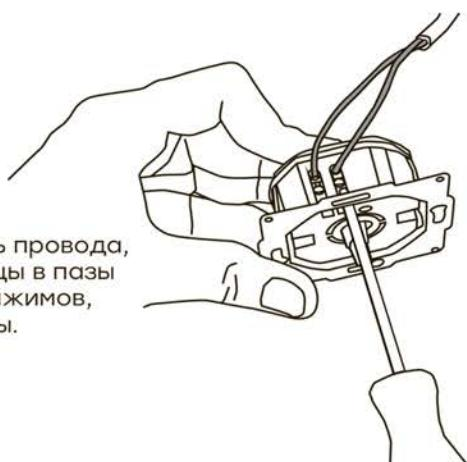
Подсоединить провода, просунув концы в пазы контактных зажимов, затянуть винты.
