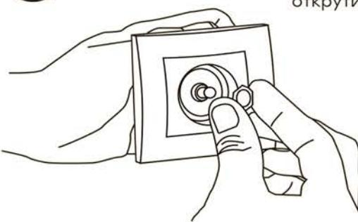
Снять лицевую крышку и рамку, открутив гайку.
