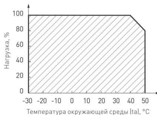
Рис. 2. Максимальная допустимая нагрузка, % от мощности источника
