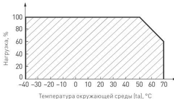
Рис. 2. Максимальная допустимая нагрузка, % от мощности источника
