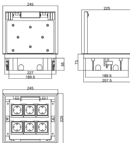
Напольные лючки Donel – решение для организации рабочих мест, как в открытых пространствах типа «Open Space», так и в индивидуальных помещениях и комнатах переговоров, предназначены для монтажа модульных электроустановочных изделий 45x45 в плиты фальш-пола или в бетонный пол.
