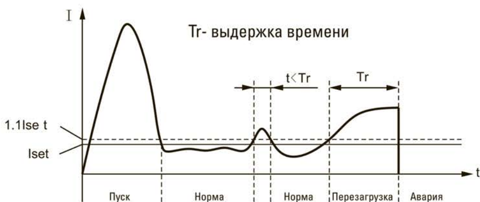
Рис. 5 Диаграмма работы реле при перегрузке
