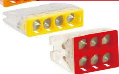
Клеммы СМК компактные 2273 с пастой EKF PROxima применяются в распределительных коробках и предназначены для присоединения и ответвления одножильных проводников из меди и алюминия или многожильного медного провода с наконечником в электрических цепях переменного тока с частотой 50 Гц напряжением до 400 В.
