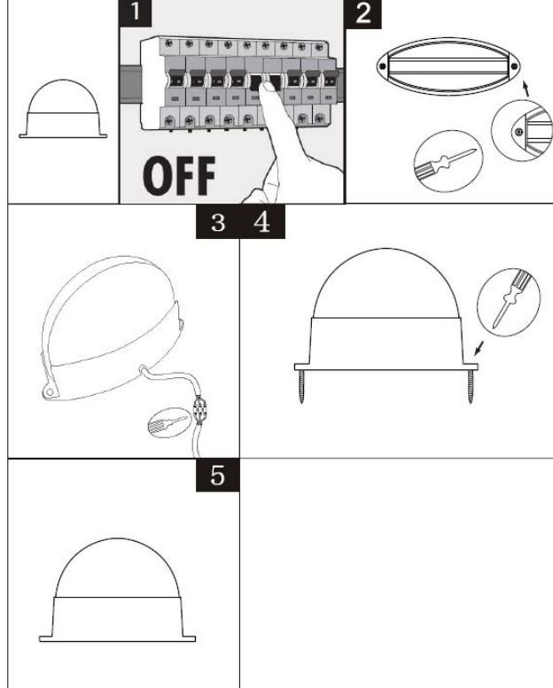
5.1 Извлеките светильник из упаковки, проверьте внешний вид и наличие всей необходимой комплектации. Перед установкой светильника убедитесь, что электрическое питание сети отключено. Подключение светильника необходимо осуществлять через устройство защитного отключения, рассчитанное на дифференциальный ток не более 30mA.
