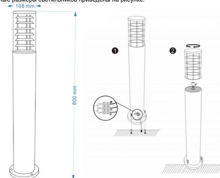
Рис. 1 Внешний вид и габаритные размеры светильника
