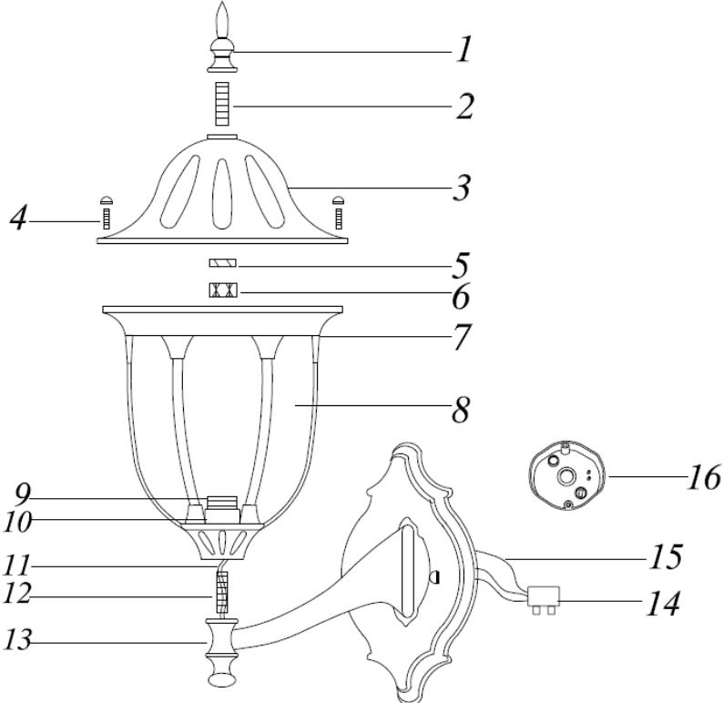
1 – балюсина; 2 – резьбовое крепление; 3 – верхняя крышка; 4 – винты; 5 – гровер; 6 – гайка; 7 – каркас; 8 – стеклянный рассеиватель; 9 – ламподержатель; 10 – патрон; 11,12 – резьбовое крепление; 13 – основание; 14 – клеммная колодка; 15 – заземляющий провод; 16 – крепежный элемент.
