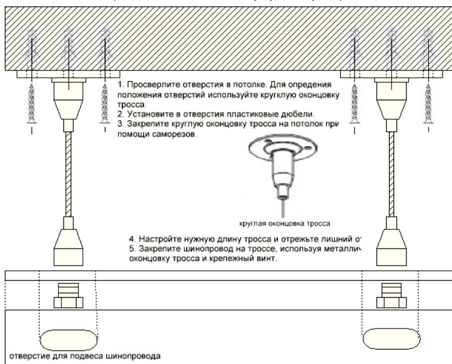
4.5 На каждом метре шинопровода имеется по два отверстия предназначенных для монтажа шинопровода.
