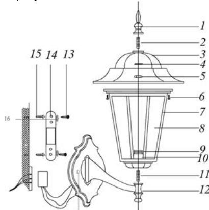
1 – балюсина; 2 – большое резьбовое крепление; 3 – крышка; 4 – гровер; 5 – гайка; 6 – винты; 7 – каркас; 8 – стеклянный рассеиватель; 9 – патрон; 10 – лампадодержатель; 11 – малое резьбовое крепление; 12 – основание; 13 – саморезы; 14 – крепежная скоба; 15 – крепежные отверстия; 16 – шайба.
