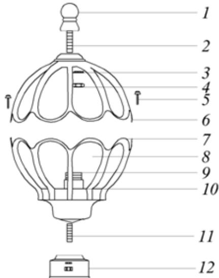
1 – балансина; 2 – резьбовое крепление; 3 – гровер; 4 – гайка; 5 – винты; 6 – верхняя крышка; 7 – нижняя крышка; 8 – рассеиватель; 9 – патрон; 10 – ламподержатель; 11 – резьбовое крепление; 12 – основание.
