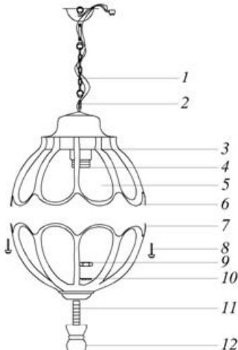
1 – цепь для подвеса; 2 – резьбовой крепеж; 3 – ламподержатель; 4 – патрон для лампы; 5 – рассеиватель; 6 – верхняя крышка; 7 – нижняя часть светильника; 8 – крепежный винт; 9 – гайка; 10 – гровер; 11 – резьбовой крепеж; 12 – декоративная балюсина.
