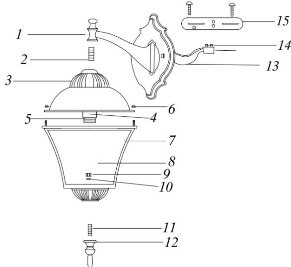
1 – основание; 2 – резьбовое крепление; 3 – верхняя крышка; 4 – патрон; 5 – ламподержатель; 6 – винты; 7 – каркас; 8 – стеклянный рассеиватель; 9 – гайка; 10 – гровер; 11 – резьбовое крепление; 12 – балансина; 13 – заземляющий провод; 14 – клеммная колодка; 15 – крепежный элемент.
