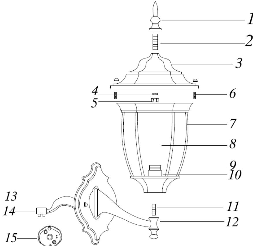
1 – балюсина; 2 – резьбовое крепление; 3 – верхняя крышка; 4 – гровер; 5 – гайка; 6 – винты; 7 – каркас; 8 – стеклянный рассеиватель; 9 – ламподержатель; 10 – патрон; 11 – резьбовое крепление; 12 – основание; 13 – заземляющий провод; 14 – клеммная колодка; 15 – крепежный элемент.
