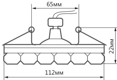
Элегантный встраиваемый светильник **CD935** украсит интерьер и предоставит возможность дополнительной подсветки помещения. Светильник подсвечивается встроенными в корпус светодиодами, что позволяет увидеть фактуру и красоту светильника во включенном состоянии.
