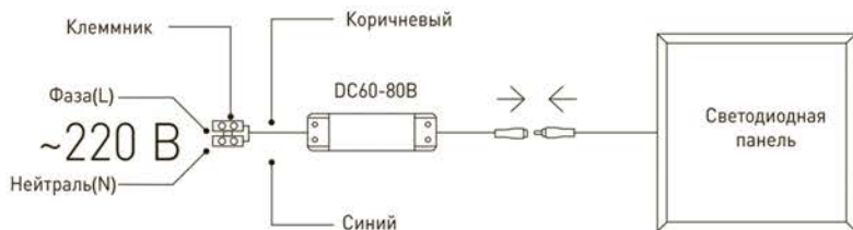
Рис.1. Схема подключения светодиодной панели к сети 220В.
