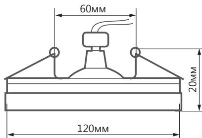
Элегантный встраиваемый светильник **CD970** украсит интерьер и предоставит возможность дополнительной подсветки помещения. Светильник подсвечивается встроенными в корпус светодиодами, что позволяет увидеть фактуру и красоту светильника во включенном состоянии.
