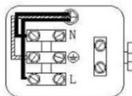
*Коричневый провод – L (фаза); синий провод – N (ноль); желто-зелёный – заземление*
