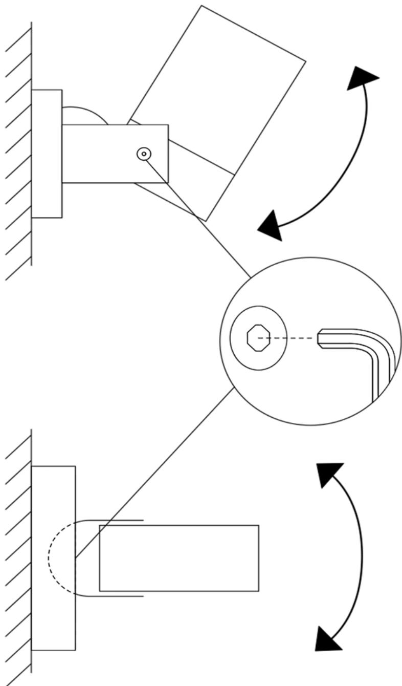
Наклоните камеру для записи видео под правильным углом.
