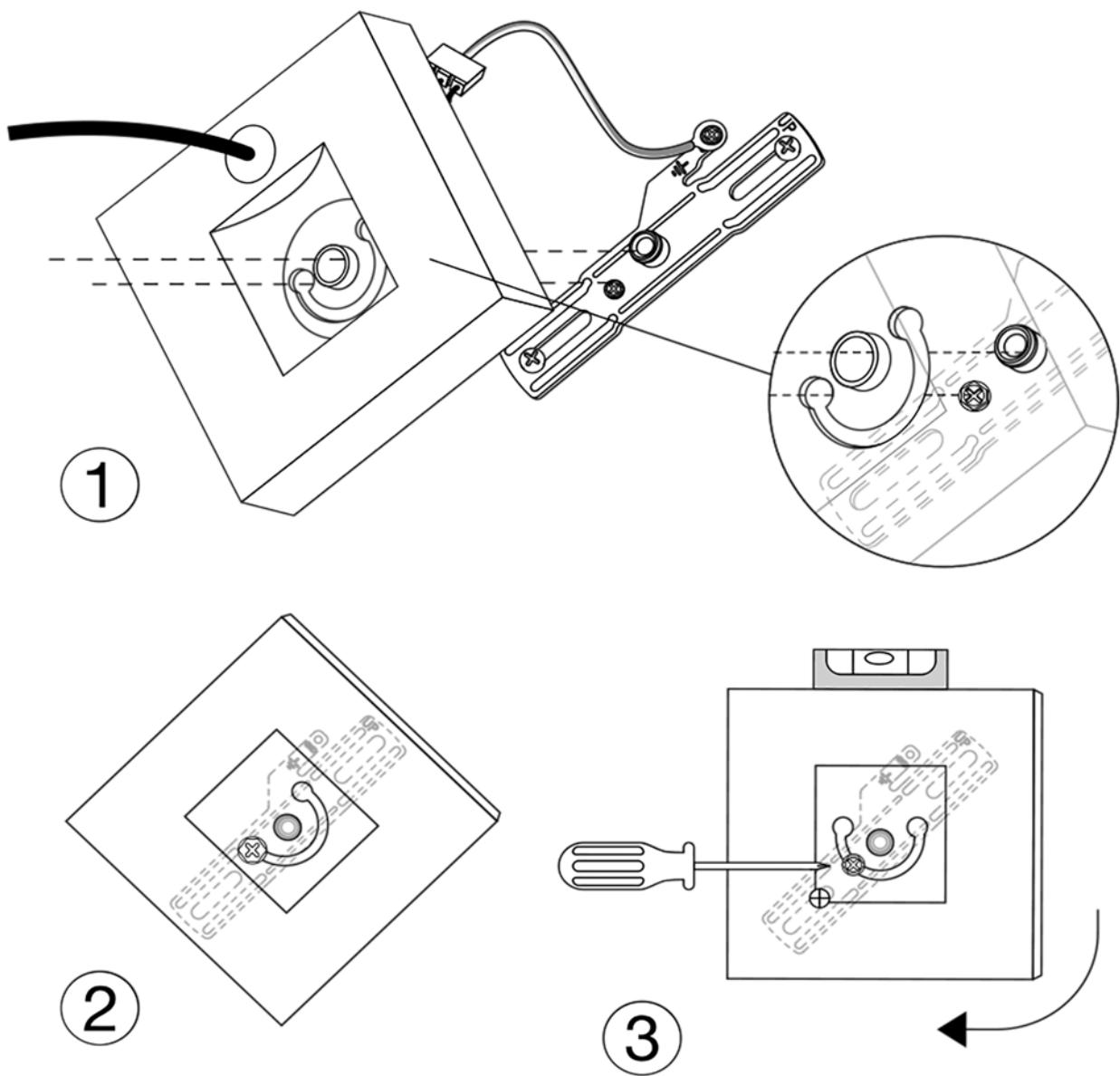
**Закрепите панель на монтажной планке.**
