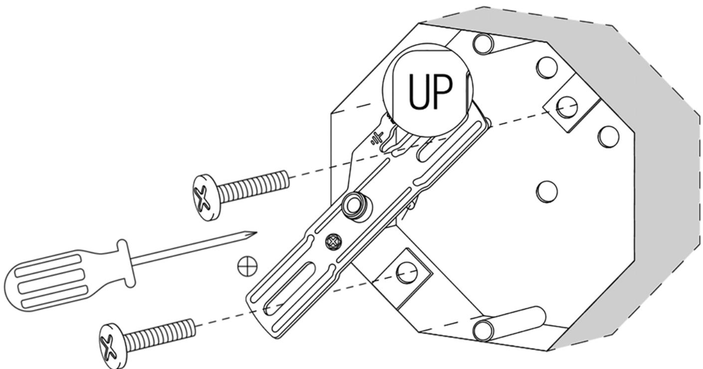
Закрепите в распределительной коробке монтажную планку.
