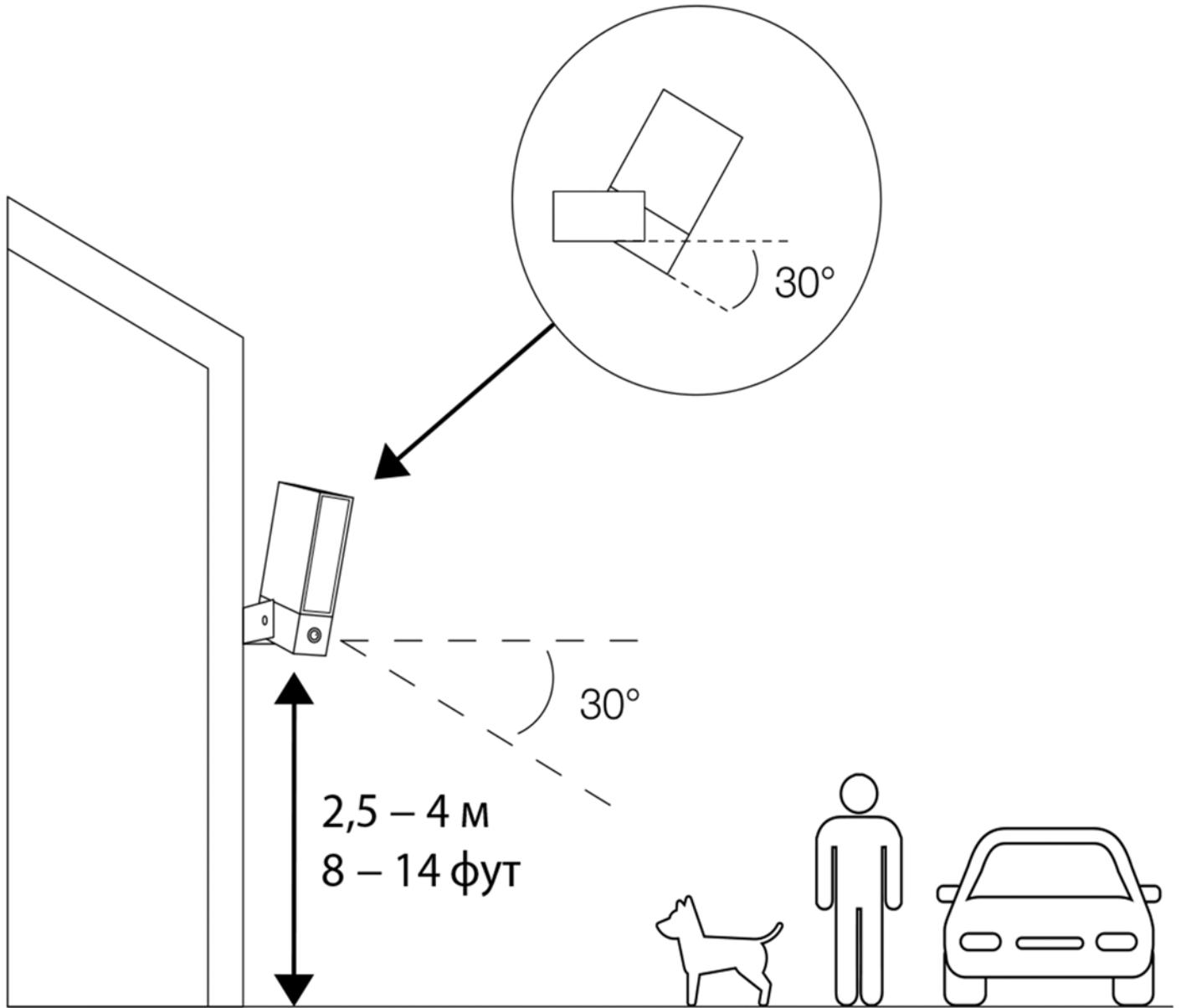
Для оптимальной производительности установите устройство на высоте от 2,5 до 4 метров и наклоните под углом примерно 30°.
