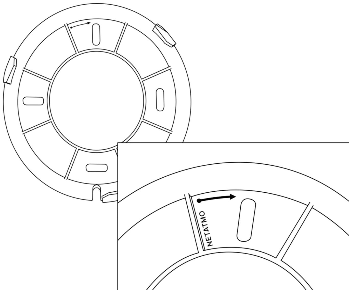
При установке монтажной панели логотип Netatmo должен располагаться сверху.
