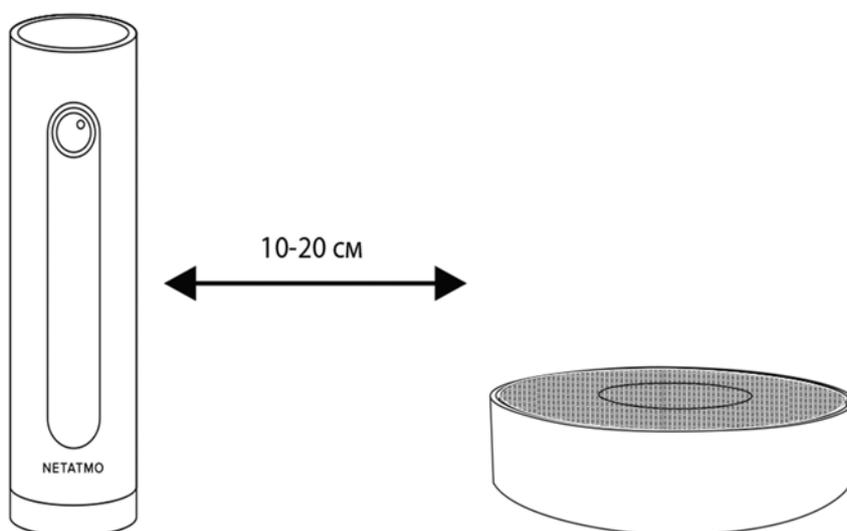
Снимите с сирены монтажную панель и расположите ее рядом с камерой на расстоянии 10 – 20 см.
