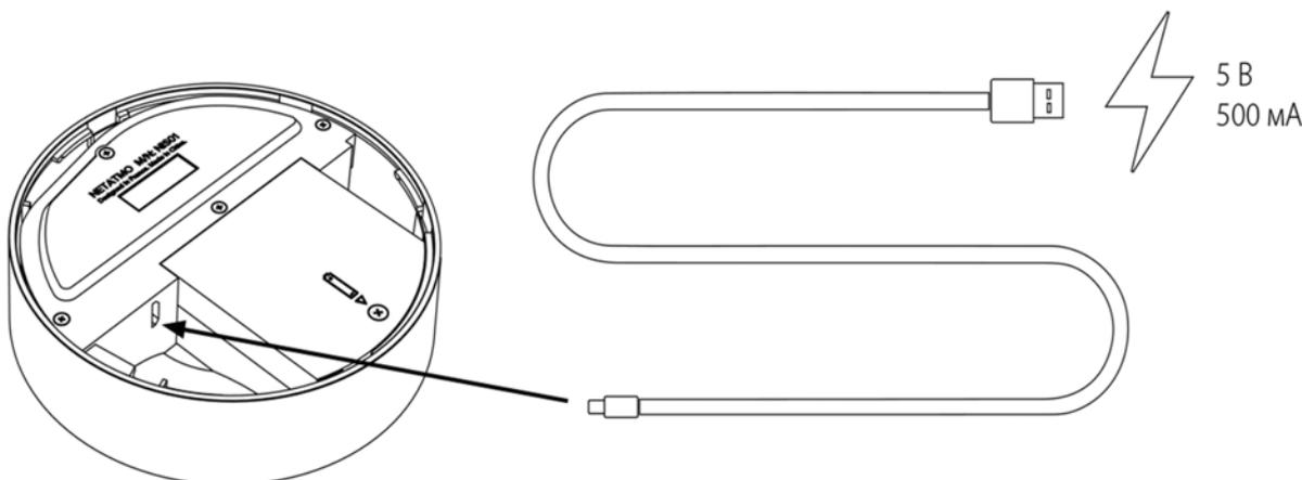
Для того чтобы сирена была постоянно включена, можно использовать адаптер питания с разъемом микро-USB (5 В, 500 мА). Батареи можно не вынимать и использовать их в качестве резервного источника питания.
