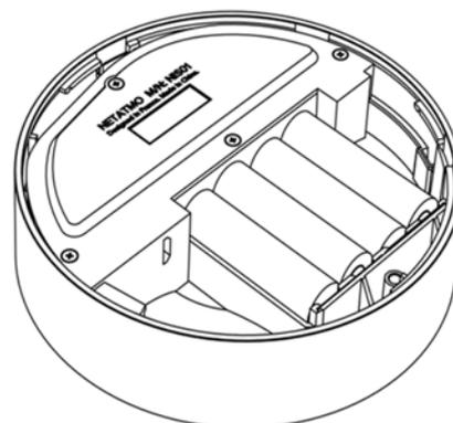
Поверните сирену против часовой стрелки и снимите ее с монтажной панели. Выкрутите указанные на рисунке винты и откройте батарейный отсек. Сирена питается от 4 пальчиковых батарей (AA). При установке батарей необходимо соблюдать полярность, указанную на держателе батарей.
