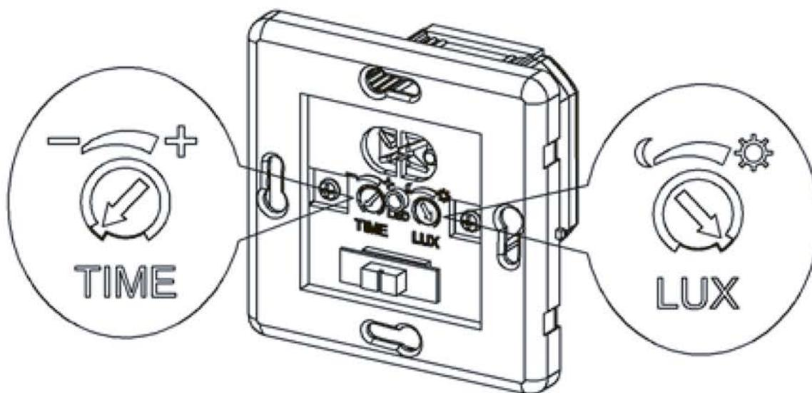
**Рис.3. Начальные установки регуляторов во время настройки датчика.**
