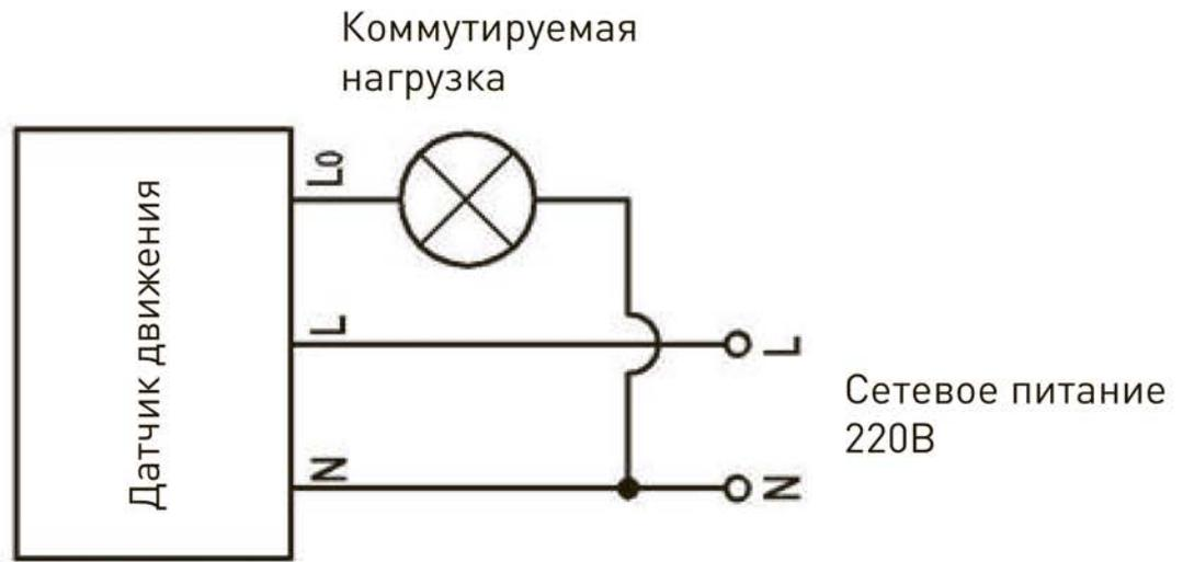
**Рис.6. Подключение датчика движения.**
