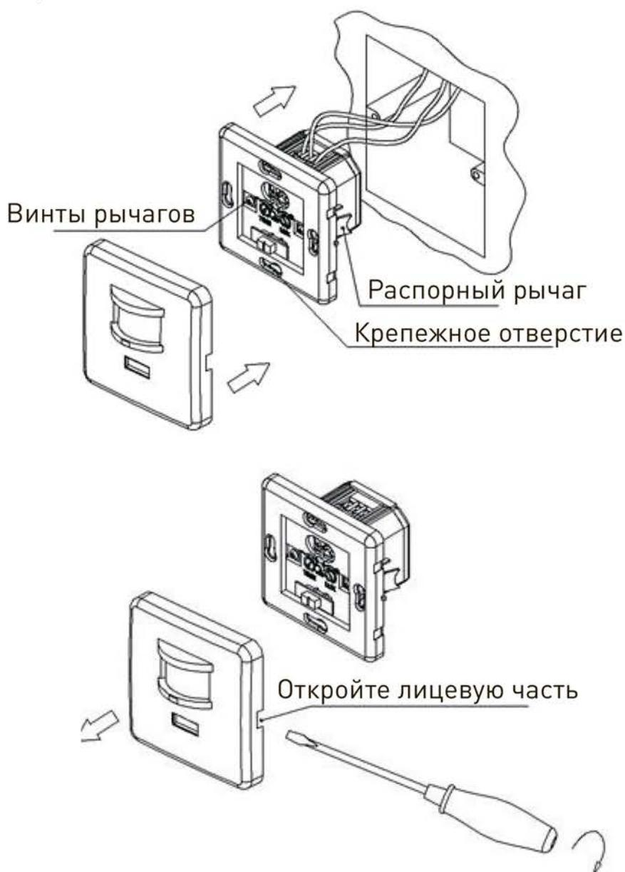
**Рис.5. Разборка и крепление корпуса.**
