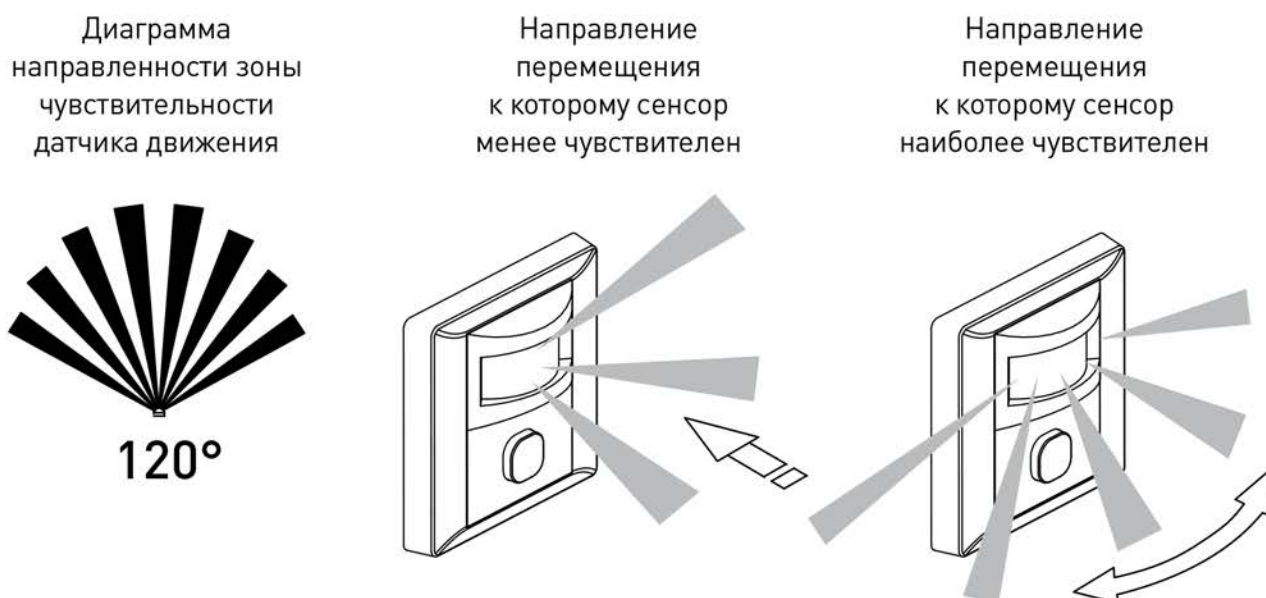
Рис.4. Диаграмма направленности зоны чувствительности.
