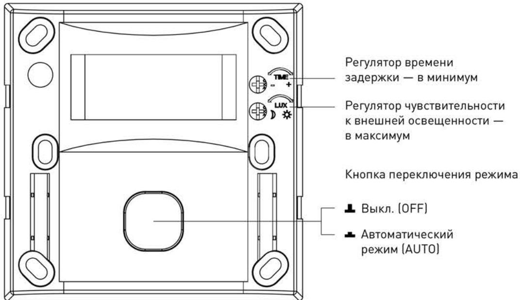
**Рис.3. Начальные установки регуляторов во время настройки датчика.**
