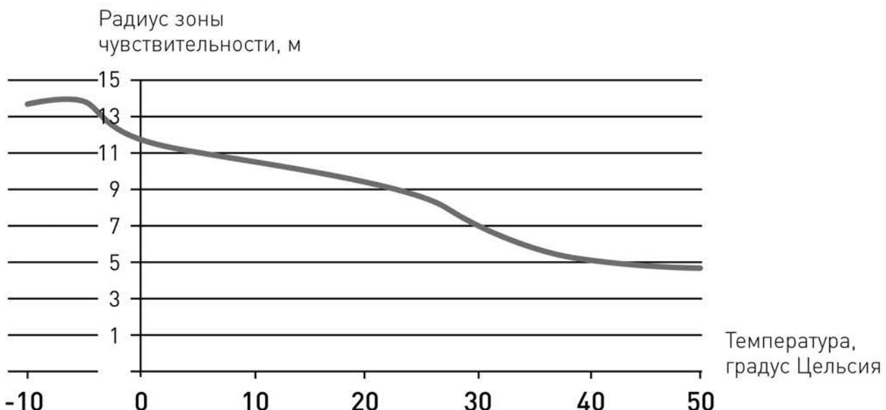
**Рис.1. График зависимости радиуса зоны чувствительности от температуры.**
