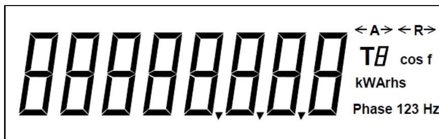
**Рисунок 4.9 – Внешний вид ЖКИ счетчика без индекса «ш» в коде**
