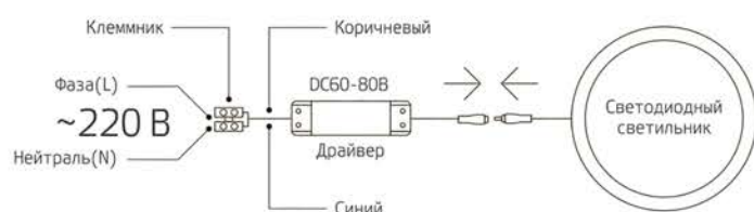
Рис. 2. Схема подключения светодиодного светильника к сети 220 В
