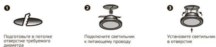
Рис. 2. Схема подключения светодиодного светильника к сети 220 В
