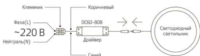
Рис. 2. Схема подключения светодиодного светильника к сети 220 В
