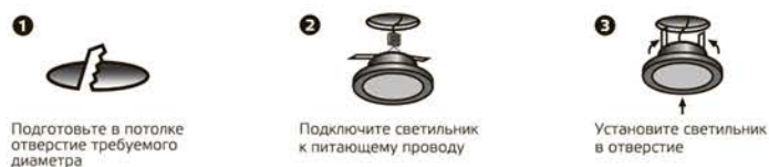
Рис. 2. Схема подключения светодиодного светильника к сети 220 В
