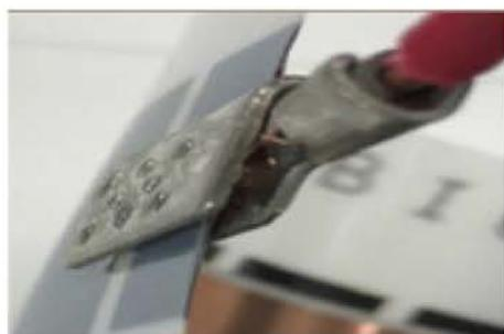
△ Ни в коем случае не допускайте установки, при которой одна сторона зажима находится внутри термопленки. Это может привести к отклеиванию поверхности и попаданию воздуха и/или влаги внутрь, и, как следствие, к возникновению искры.
