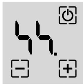
При неисправности датчика температуры на ЖК-дисплее отображается некорректное значение температуры вне границ работы терморегулятора (меньше  $+5\text{ }^{\circ}\text{C}$  или больше  $+55\text{ }^{\circ}\text{C}$ ) или постоянно звучит звуковой сигнал и на ЖК-дисплее отображается:
