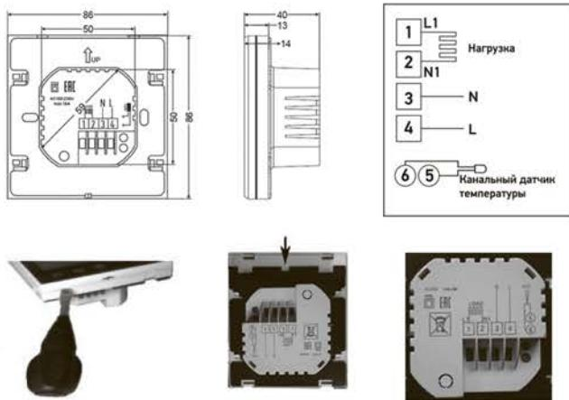
Чтобы вскрыть терморегулятор, поместите конец плоской отвертки в обе разъема в основании терморегулятора.
